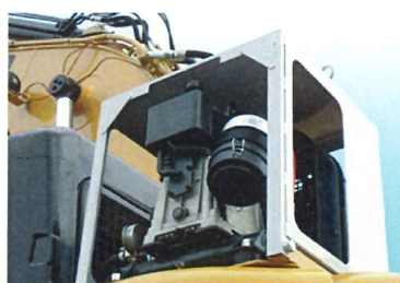
エアコンプレッサ取付け事例
