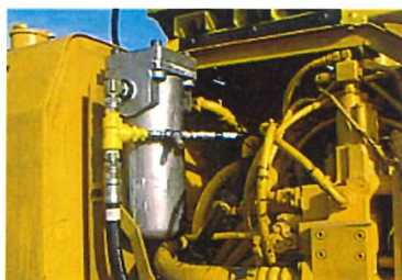
ラインフィルタ取付け事例
